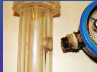
محل اتصال گیج خلاء به بدنه لوله تانسیومتر
