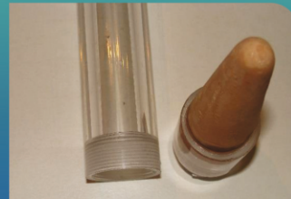
کلاهک سرامیکی تانسیومتر و محل اتصال آن به بدنه دستگاه
