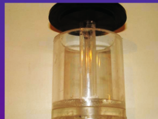
تانکر ذخیره آب به همراه در پوش و میل ورود آب برای آبیگری دستگاه
